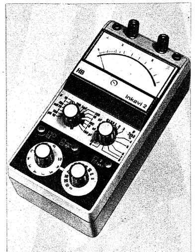
▲ Bild 2. ► LC-Meßbrücke mit Verlustwinkelabgleich Typ Inkavi 2 (Hartmann & Braun)
